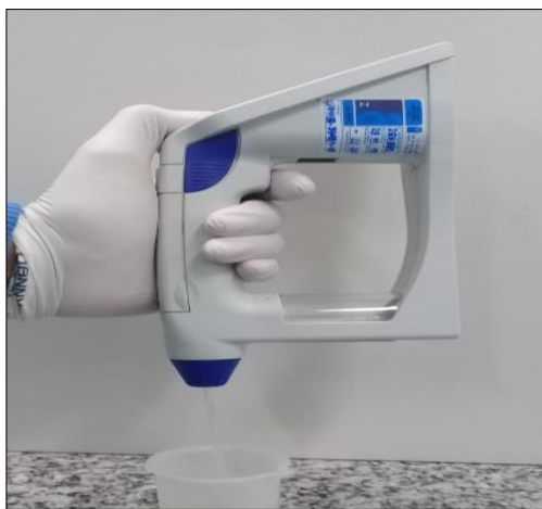
Figura 4. Equipamento Densímetro 30 PX ® (Mettler Toledo, Brasil) aspirando amostra (União Química Farmacêutica Nacional S/A- Unidade de Pouso Alegre).
