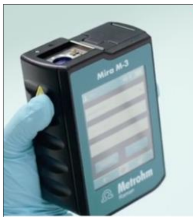
Figura 24. Raman, modelo Mira M3 (fabricante Metrohm, Estados Unidos)
