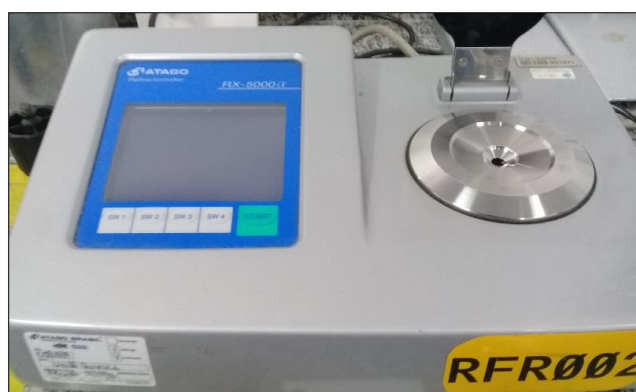
Figura 6. Refratômetro digital automático ATAGO RX 5000 ALPHA (Cetec, Brasil) (União Química Farmacêutica Nacional S/A- Unidade de Pouso Alegre).
