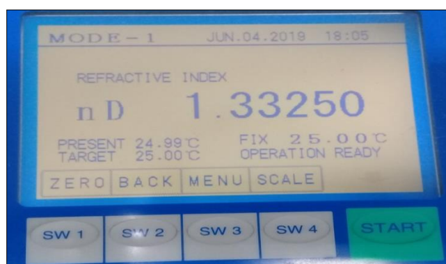
Figura 7. Display do equipamento refratômetro digital automático ATAGO RX 5000 ALPHA (Cetec, Brasil) com as informações da calibração realizada com água (União Química Farmacêutica Nacional - Unidade de Pouso Alegre).
