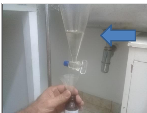
Figura 3. Separação das fases oleosa e aquosa do óleo de Melaleuca armillaris (Laboratório de Botânica – UNIVAS).
