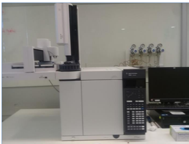
Figura 17. Cromatógrafo Gasoso modelo 7890B Agilent ® (Estados Unidos) (Laboratório científico Agilent Technology ).
