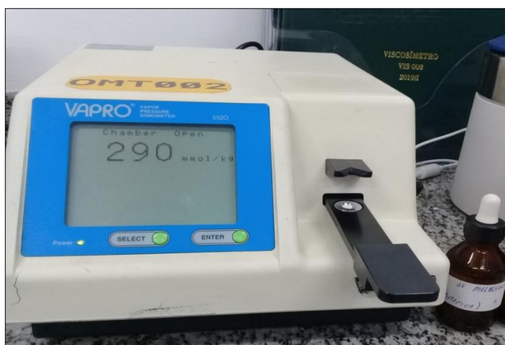
Figura 8. Osmômetro Vapro modelo 5520 (Wescor, Estados Unidos) (União Química Farmacêutica Nacional S/A-Unidade de Pouso Alegre).
