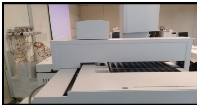
Figura 20. Rack de vials do amostrador G4513, Agilent ® , Estados Unidos (Laboratório científico Agilent Technology ).
