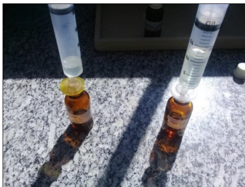
Figura 11. Filtração do óleo de Melaleuca armillaris com membrana lipofílica (Millipore ® , Brasil) (Laboratório de botânica - UNIVÁS).
