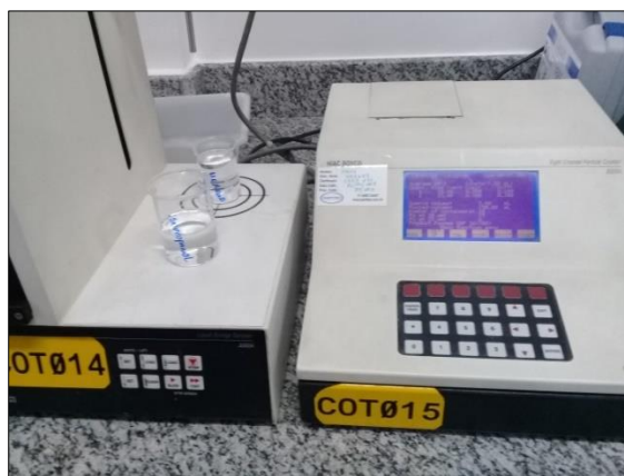
Figura 10. Contador de partículas HIAC, modelo 8000A (fabricante Hach, Brasil) (União Química Farmacêutica Nacional S/A- Unidade de Pouso Alegre).
