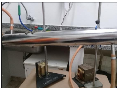
Figura 2. Condensador para separação por hidrodestilação de compostos voláteis do óleo de Melaleuca armillaris (Laboratório de Botânica – UNIVAS).
