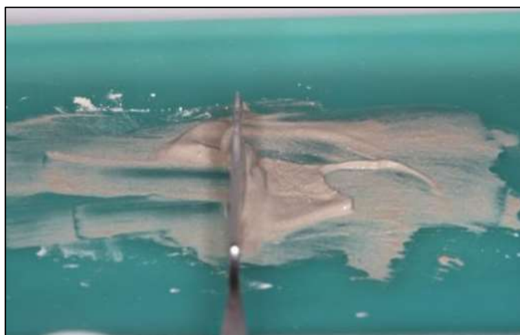
Figura 8 - Manipulação do cimento com espátula flexível sobre placa de vidro.
